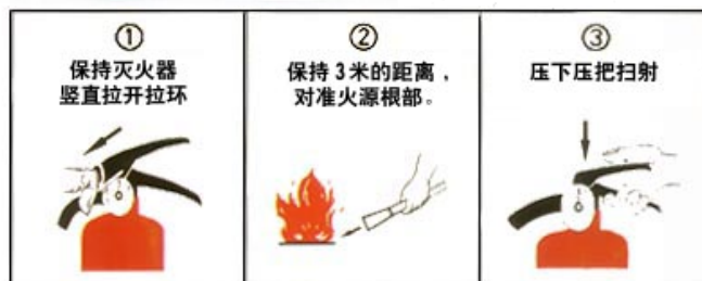
常见灭火器的样式、构造及使用方法
